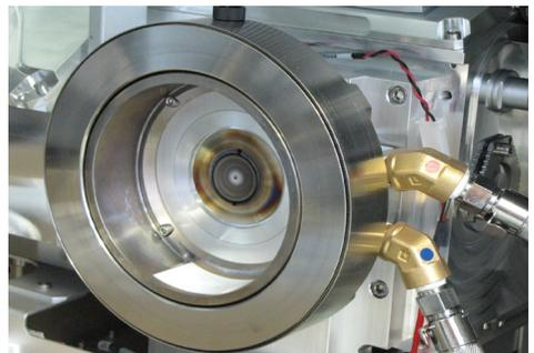
Foto 5: ... bevor die Ionen durch die Konen in den Quadrupol eintreten.
