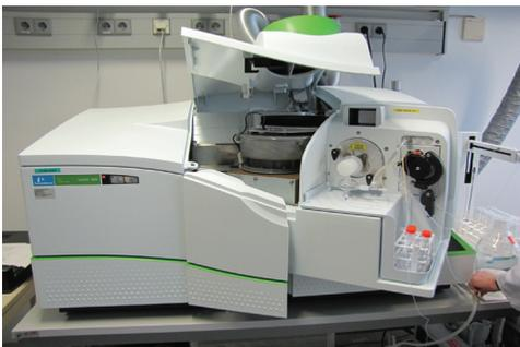
Foto 2: Das neue ICP-MS kann durch erleichterten Zugang zu den Bauteilen sehr einfach gewartet werden.
