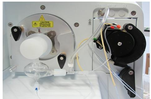
Foto 3: Die Probe gelangt mithilfe der peristaltischen Pumpe durch den Zerstäuber in die Sprühkammer ...
