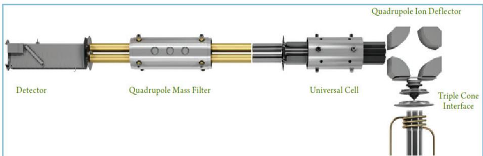
Abb. 1: Schematischer Aufbau des ICP-MS, Quelle: PerkinElmer
