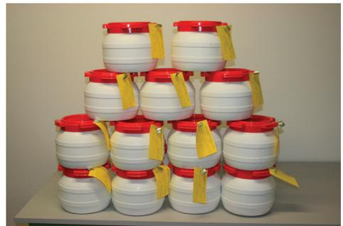
Foto: Gärrestproben in verplombten Kunststoffbehältern
