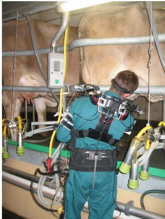
**Bild 1:** Melker ausgerüstet mit dem Computer-unterstützten Erfassung und Langzeit-Analyse (CUELA) System.
