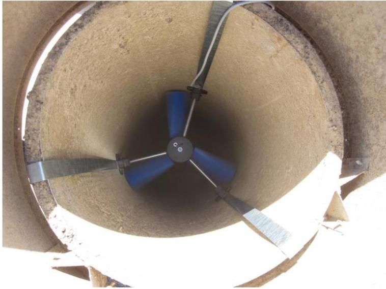
Abb. 31: Von oben eingebauter Messventilator.
