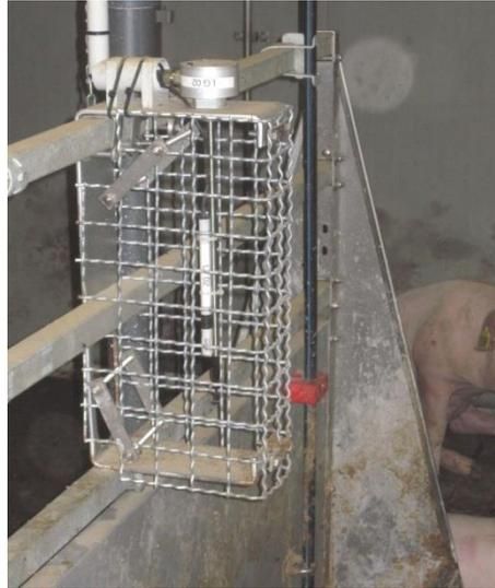
Abb. 26 Messsensoren im Schutzkäfig
