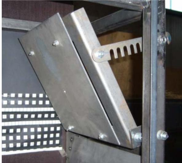
**Bild 8:** Prallplattenkonstruktion – austauschbarer Prallkörper und Winkelverstellung
