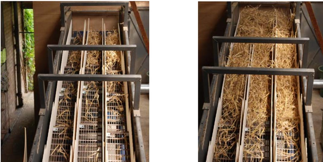
**Bild 2:** Hordenschüttler mit seitlichen Erhöhungen bei unterschiedlichen Massendurchsätzen.
