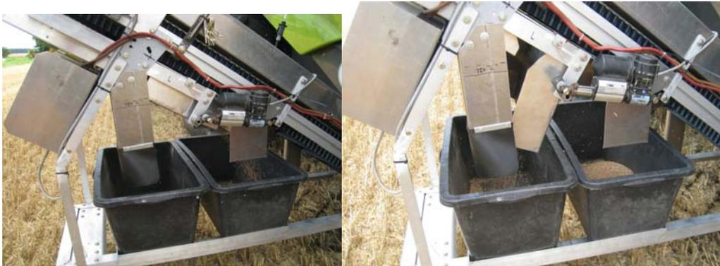
**Bild 3:** Links Förderung in Behälter, rechts Förderung während Messung
