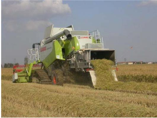
**Bild 2:** Angebautes Strohwiegeband und Ablage auf 10m Tuch
