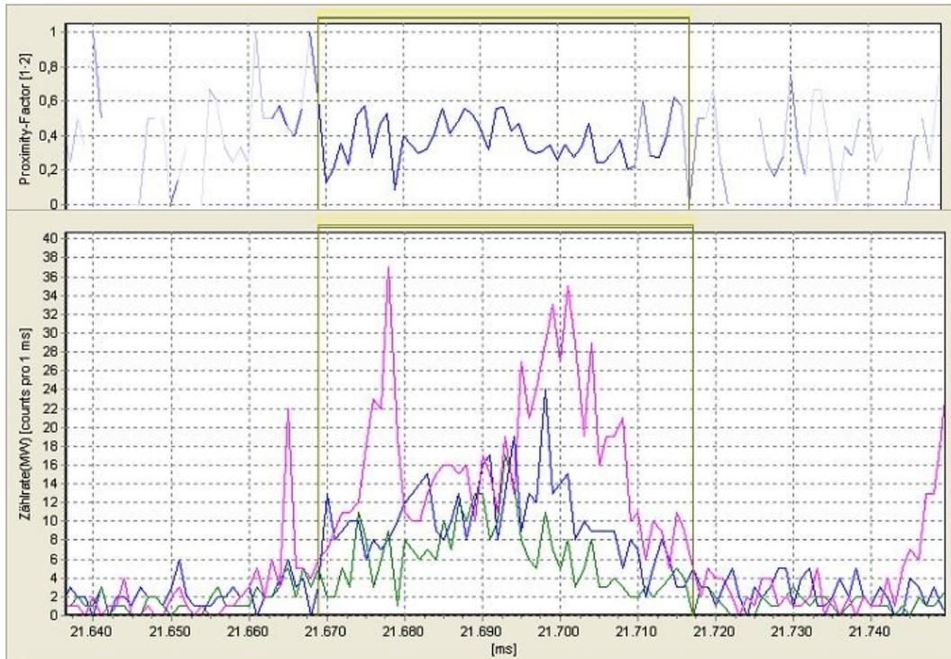
**Abbildung 2.4-6:** Einzel-Photonen-Burst mit den Donor- (blau), FRET- (grün) und Akzeptortest-Signalen (rot). Im oberen Teil der Abbildung ist der aus den FRET-Signalen berechnete Proximity Faktor ( $E_{\text{FRET}}$ ) abgebildet.
