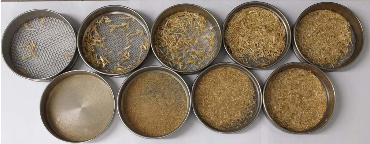
Abbildung 5-4: Ergebnis einer Siebanalyse von gepalltem Triticalestroh anhand der beladenen Siebböden
