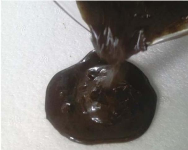
Abbildung 2-16: Maissilagehydrolysat nach Dampfvorbehandlung [DIETZ UND BOLES 2013]
