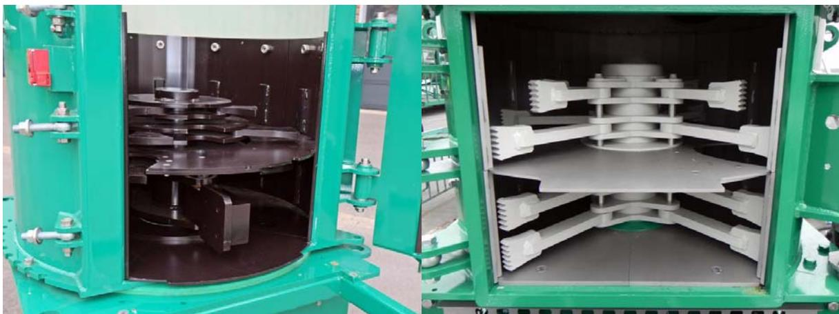
Abbildung 2-8: Prallzerkleinerer HPZ 1200 (links) und HPZ 900 (rechts) der Fa. Huning [HUNING O.J.a]
