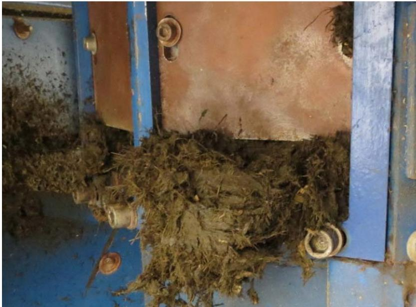
Abbildung 5-1: Mit der Substratmischung verstopfte Siebe
