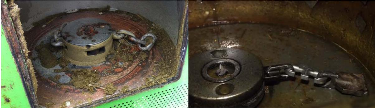
Abbildung 2-7: Querstromzerspaner der Fa. MeWa (links) und der Fa. Xergi (rechts) [XERGI 2015]
