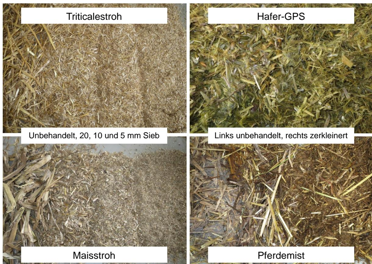
Abbildung 5-2: Untersuchte Substrate vor und nach der Zerkleinerung mit dem Prallreaktor
