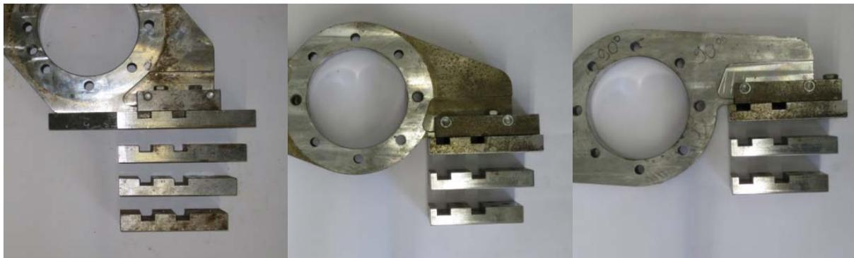
Abbildung 4-3: Darstellung der drei Rotoren  $60^\circ$ ,  $75^\circ$  und  $90^\circ$  (von links nach rechts) mit den passenden Prallelementen
