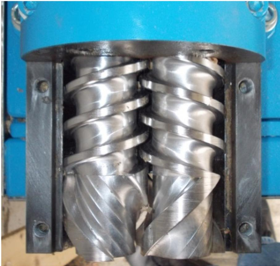
Abbildung 2-11: Blick auf die Schnecken des Laborextruders der FH Münster von der Fa. Lehmann UMT GmbH
