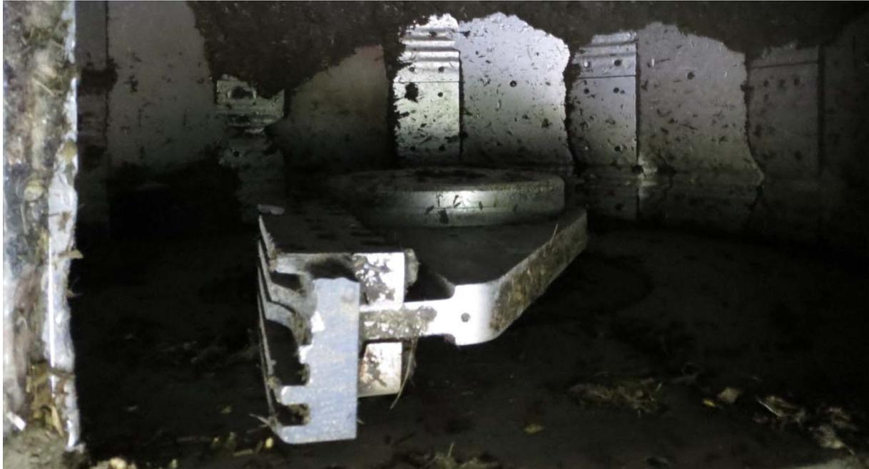
Abbildung 5-50: Prallraum des Prallreaktors der Biogasanlage Sehanö
