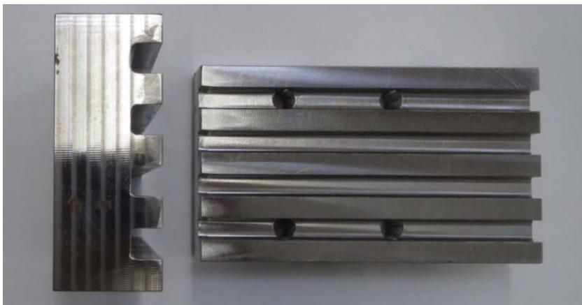
Abbildung 4-5: Genutete Parallelemente für 60°-Rotor
