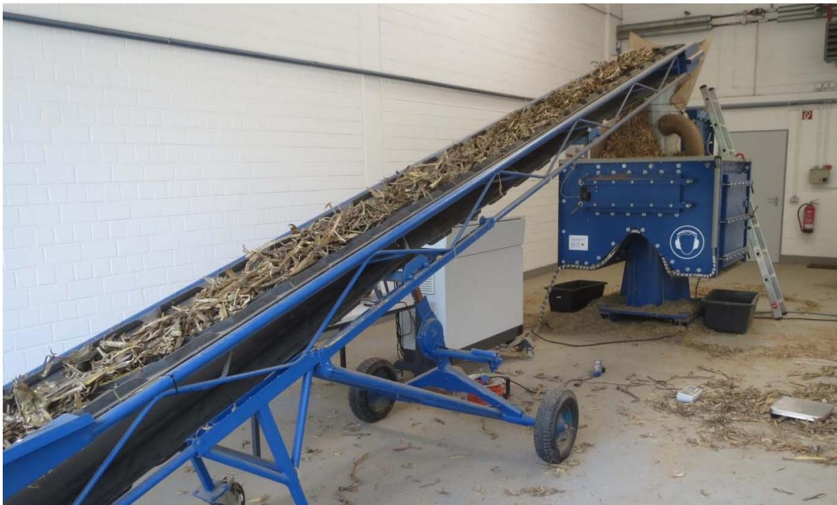
Abbildung 4-10: Versuchsaufbau für einen Zerkleinerungsversuch mit Maisstroh
