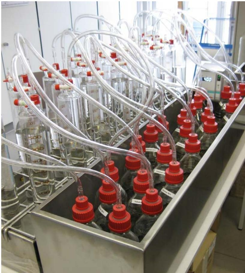
Abbildung 5-23: Eudiometer-Versuchsstand zur Biogaspotenzialbestimmung
