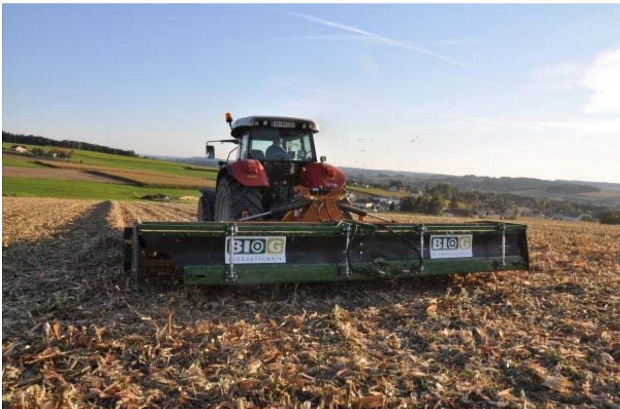
Abbildung 3-1: Schlegelmulcher Biochipper der Fa. BioG Biogastechnik GmbH [EDER UND FLESCHHUT 2014]
