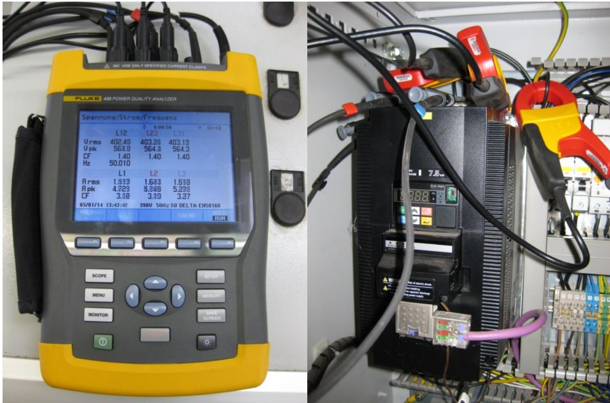
Abbildung 5-35: Mobiles Strommessgerät Fluke 435 Power Quality Analyzer (links) und Messpunkt Frequenzumrichter (rechts)
