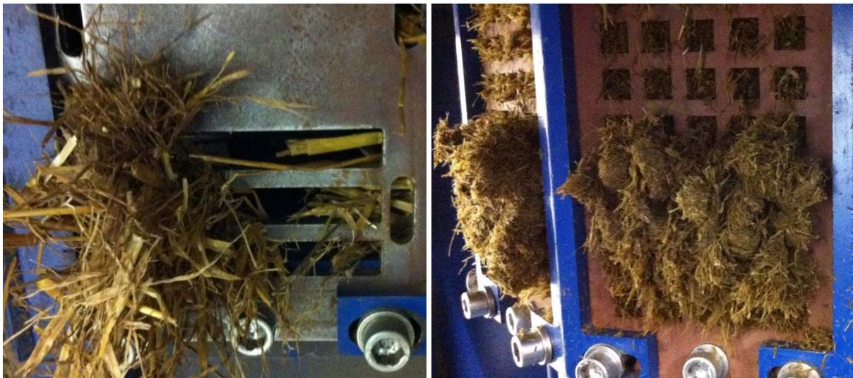
Abbildung 4-11: Teilweise mit Triticalestroh verstopftes rechteckiges Sieb (links) und mit Hafer-Ganzpflanzensilage verstopftes quadratisches 20 mm Sieb (rechts)
