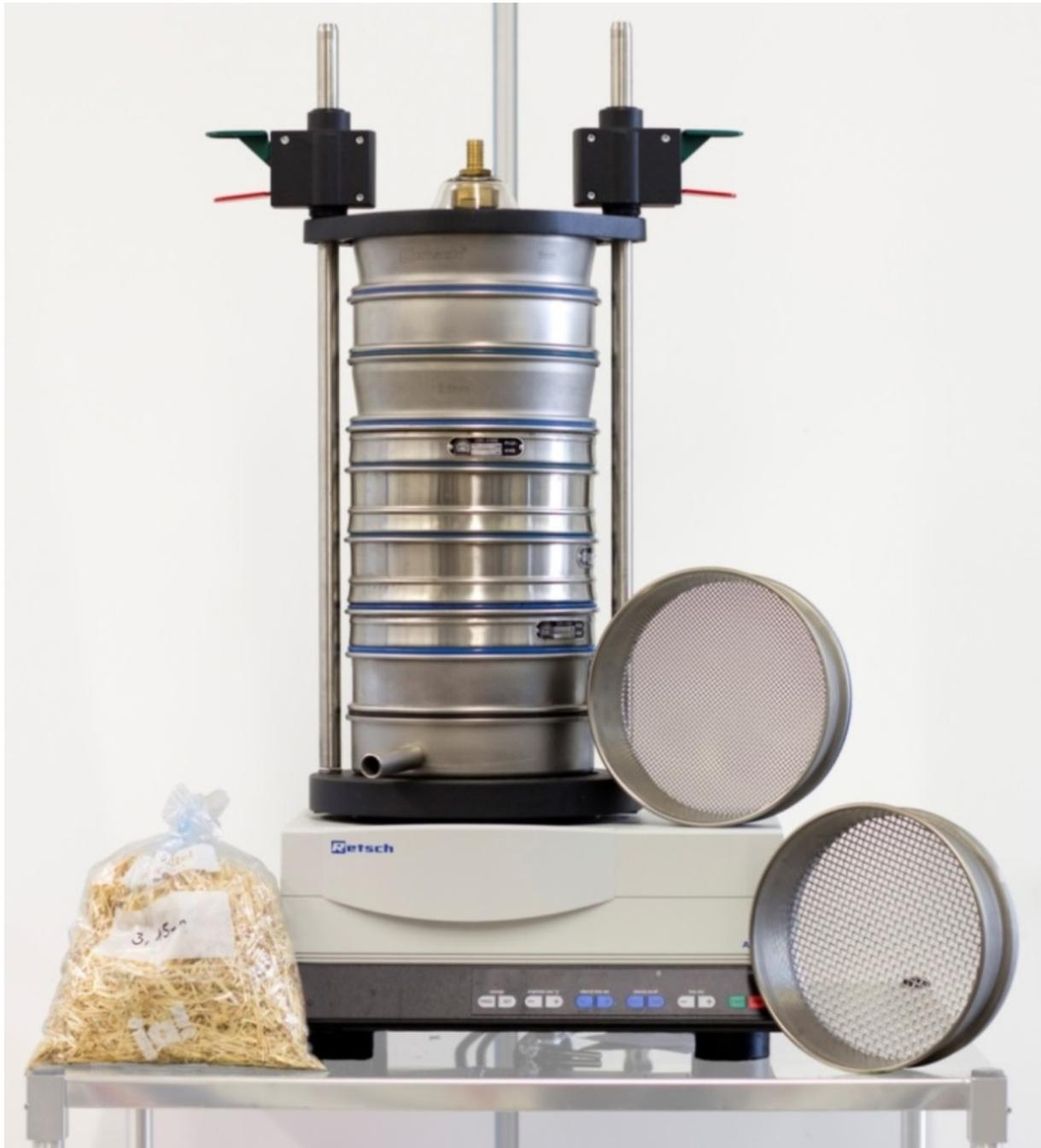
Abbildung 5-3: Verwendete Vibrationssiebmaschine AS 200 Control der Fa. Retsch
