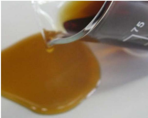
Abbildung 2-18: Weizenstrohydrolysat nach Vorbehandlung mit konzentrierter Salzsäure [DIETZ UND BOLES 2013]
