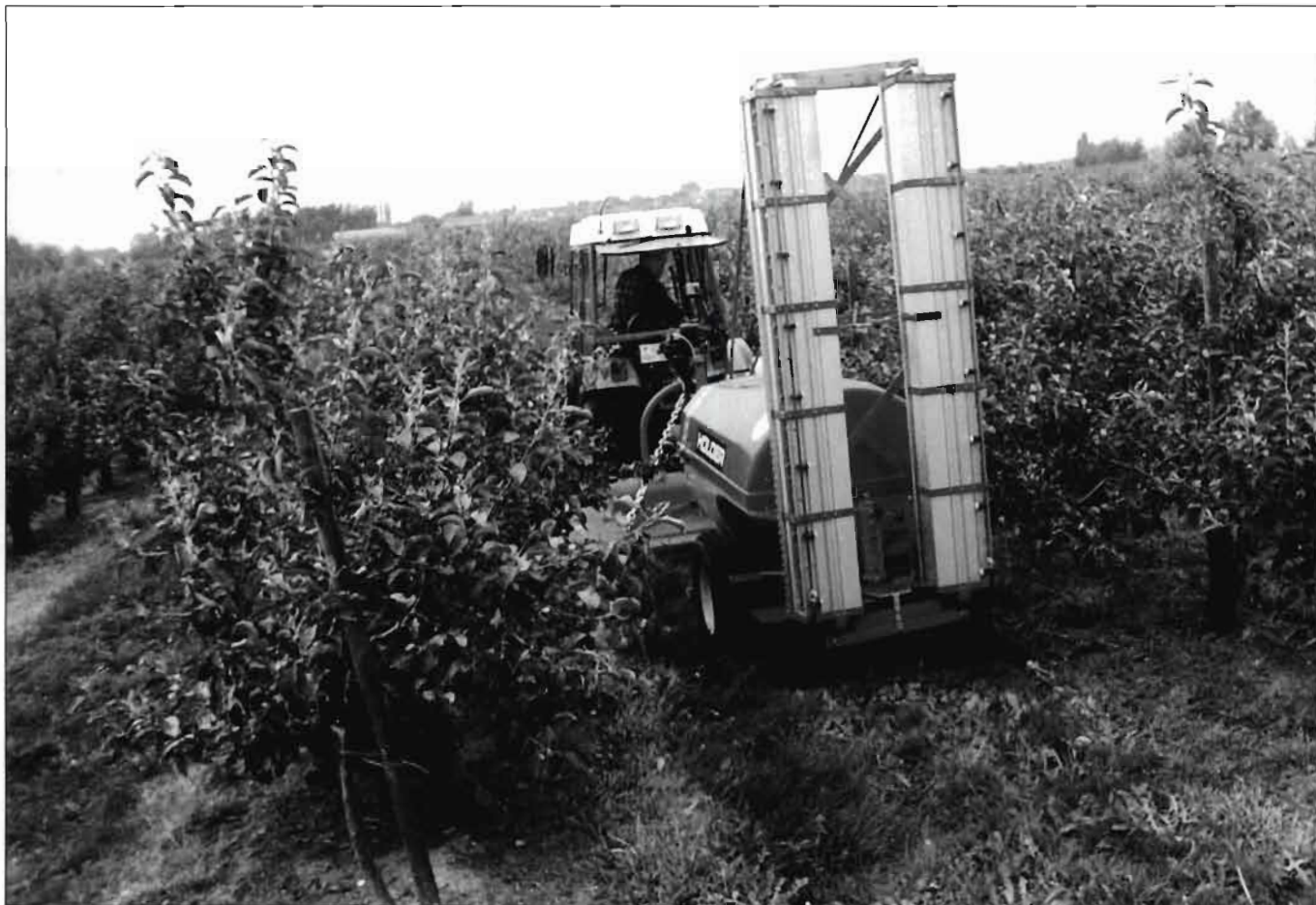
Bild 2: Ab 1985 bereicherten die Querstromgebläse QU 40 für den Niederstammobstbau bis ca. drei Meter Baumhöhe das internationale Angebot
