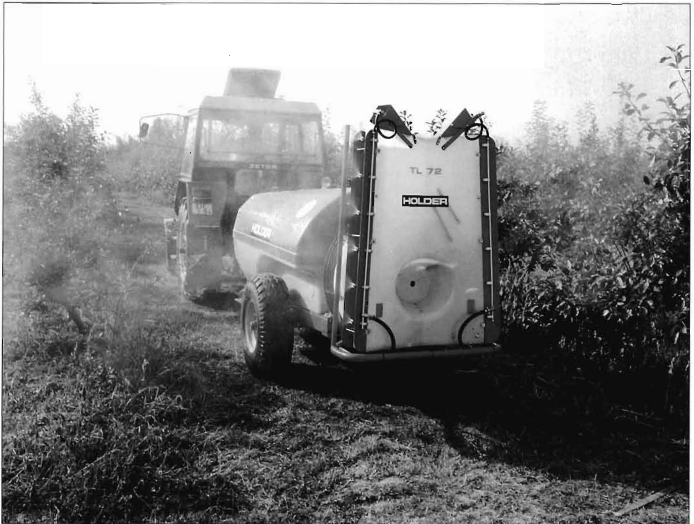
Bild 5: Als Alternative für den Obstbau kamen die TL 72 -Schrägströmer. Dieses Foto eines 1500-Liter-Anhängers stammt aus Lohmen bei Dresden
