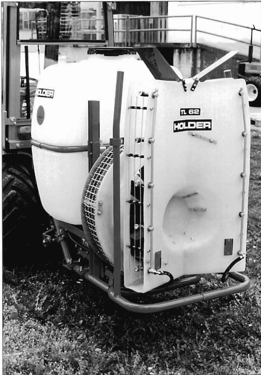
Bild 4: Da die „Querströmer“ zwar gut, aber ziemlich teuer waren, brachte erst Jakoby, dann auch Holder/Platz die TL-Schrägströmer als Alternative
