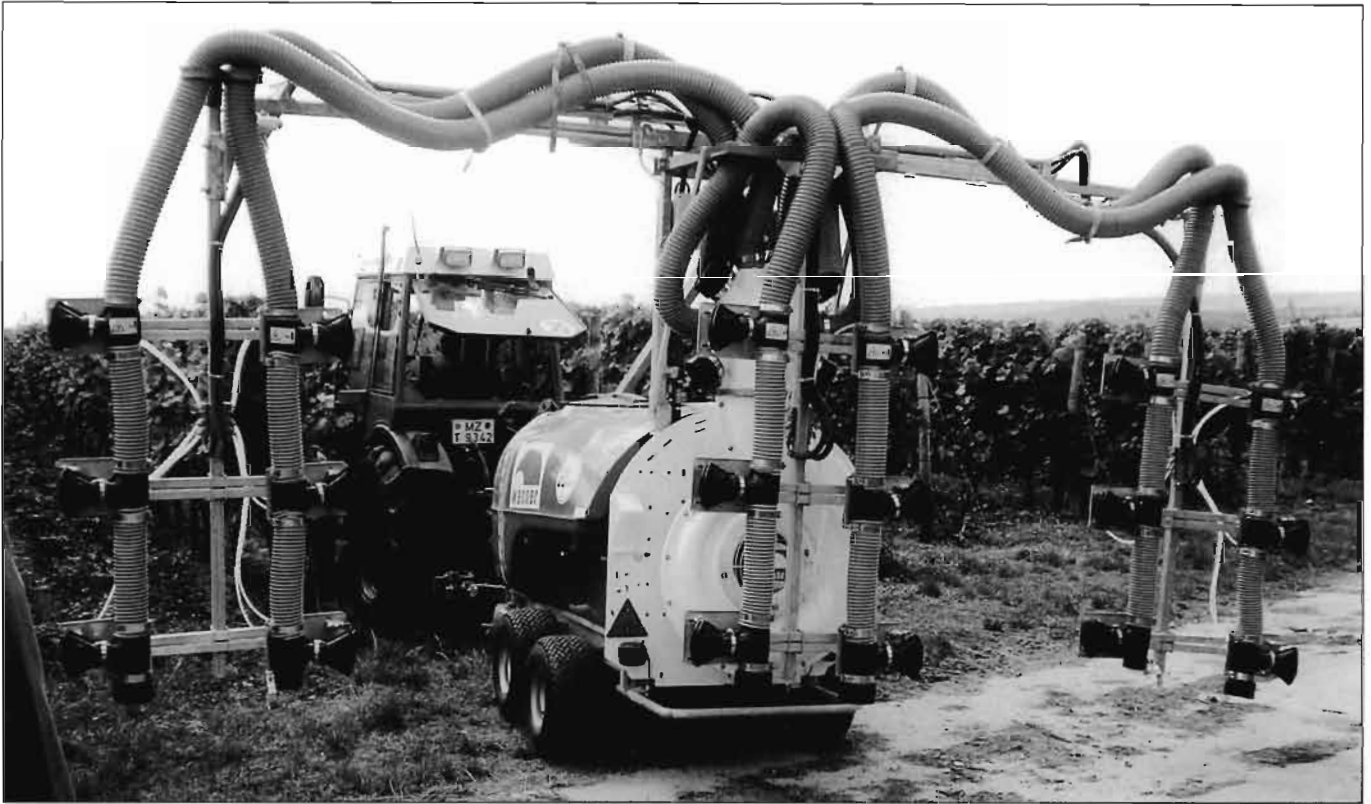
Bild 10: Mit diesen Fächerdüsen-Radial-Mehrzeilen-Geräten spricht Wanner größere Weinbaubetriebe an. Die Ausleger werden hydraulisch geklappt
