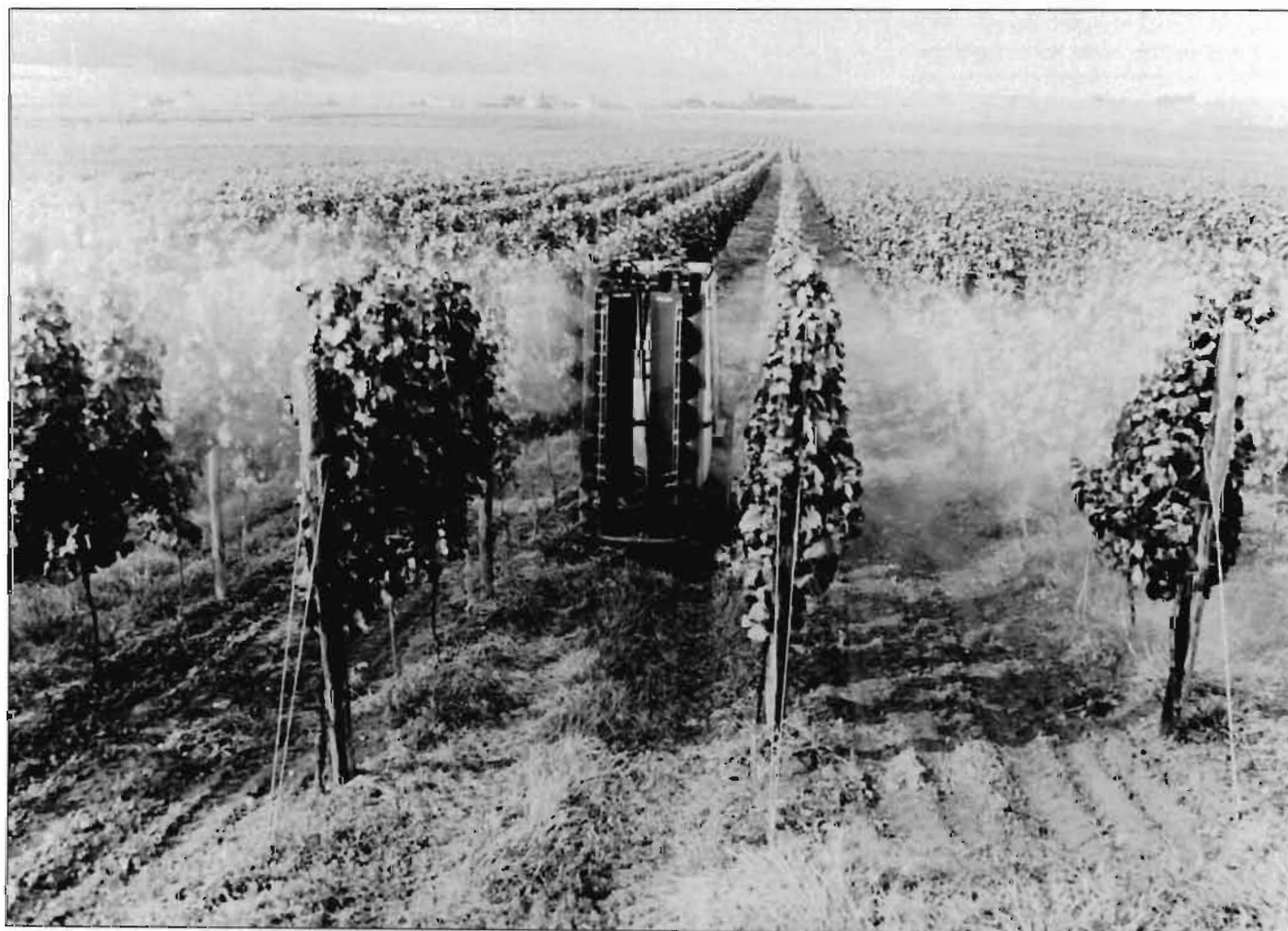
Bild 1: Seit 1982 kamen mit den Querstromgebläsen QU 20 erstmalig Sprühgeräte „ohne technisch bedingte Abtrift nach oben“ auf den Markt
