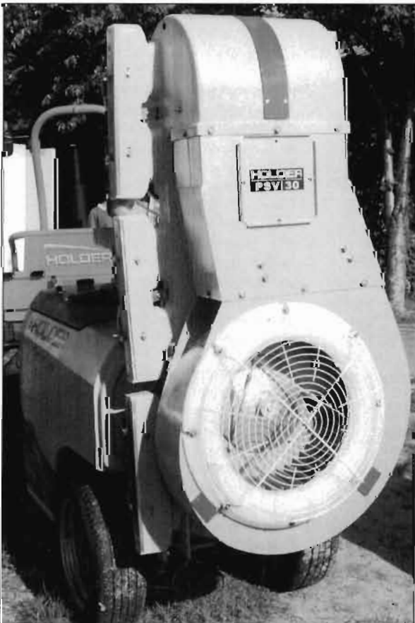
Bild 11: Mit den PSV (= Parallel-Symmetrie-Variable-) Sprühgeräten ist eine bessere Luftstrom-Geometrie gelungen als beim Tangentialgebläse
