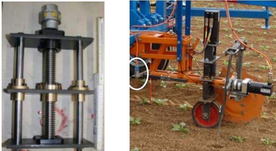
**Bild 44:** Spindeltrieb für Tiefenführung (links); Tiefenführung mit Hackwerkzeug und Ultraschallsensor (weißer Kreis) (rechts)
