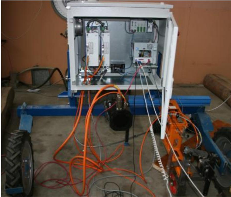
**Bild 40:** Schaltschrank mit Leistungselektronik und PC-Bildverarbeitung bei Inbetriebnahme
