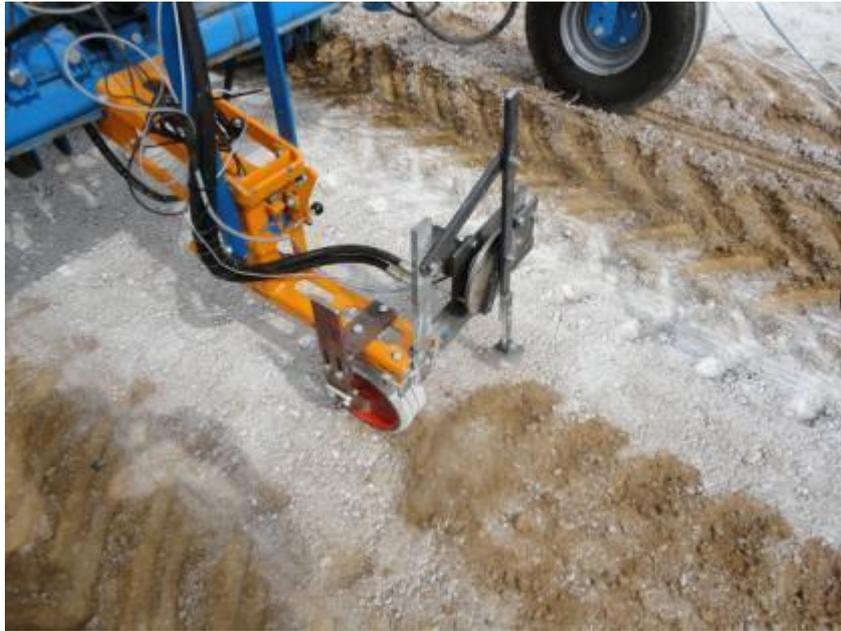
**Bild 36:** Neu entwickeltes Hackwerkzeug auf präparierter Versuchsbahn
