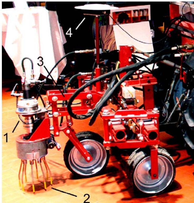
**Bild 19:** Zyklidenhacke: 1: Hydraulikmotor; 2: Zinkenrotor; 3: Parallelogramm; 4: GPS-Antenne (geändert nach Gobor 2007)
