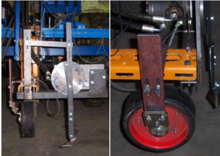
**Bild 35:** Funktionsmuster des Hackwerkzeugs (links); variable Tiefenführung (rechts)
