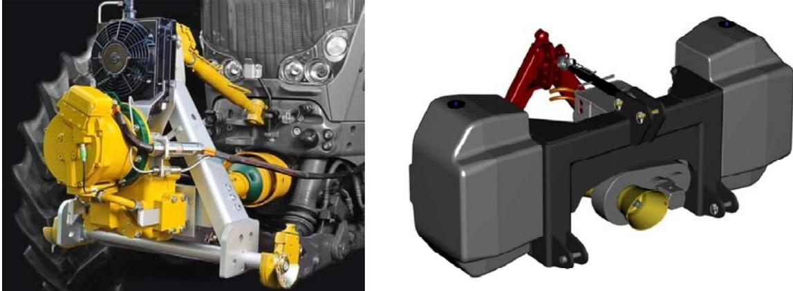
**Bild 8:** Powerpacksysteme von GKN Walterscheid (links) und Zuidberg/STW (rechts)
