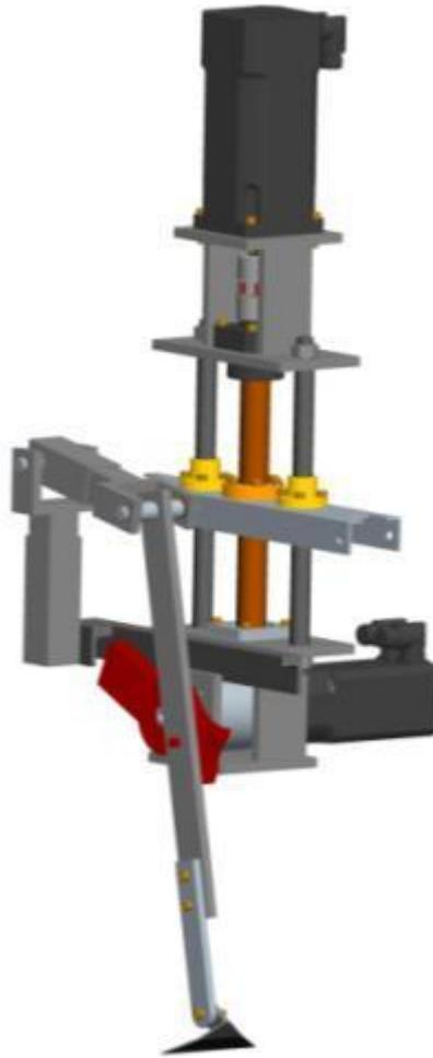
**Bild 50:** Zusammengeführte Baugruppe Tiefenführung und Hackwerkzeug
