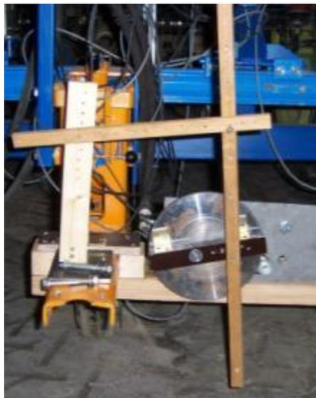
**Bild 34:** Holzmodell der Werkzeugumlaufbahn des zu entwickelnden Hackwerkzeugs
