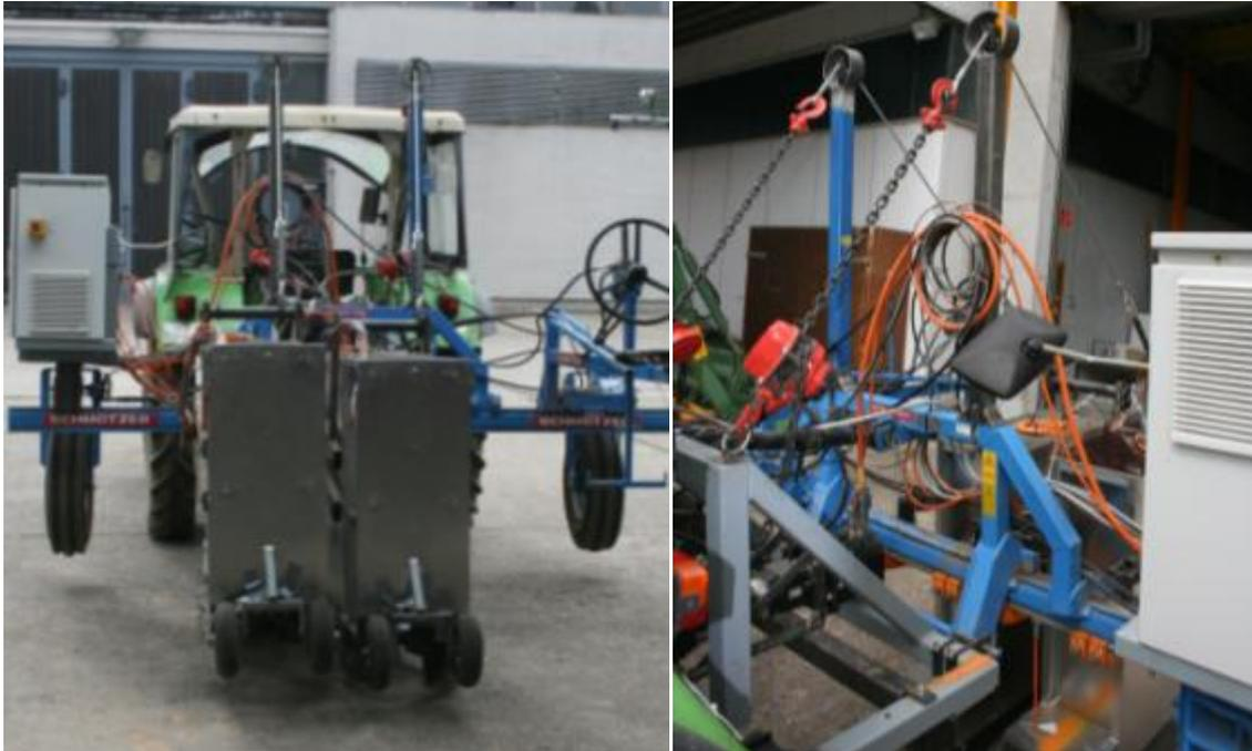
**Bild 52:** Parallelogramme in ausgehobenem Zustand mit Galgenkonstruktion
