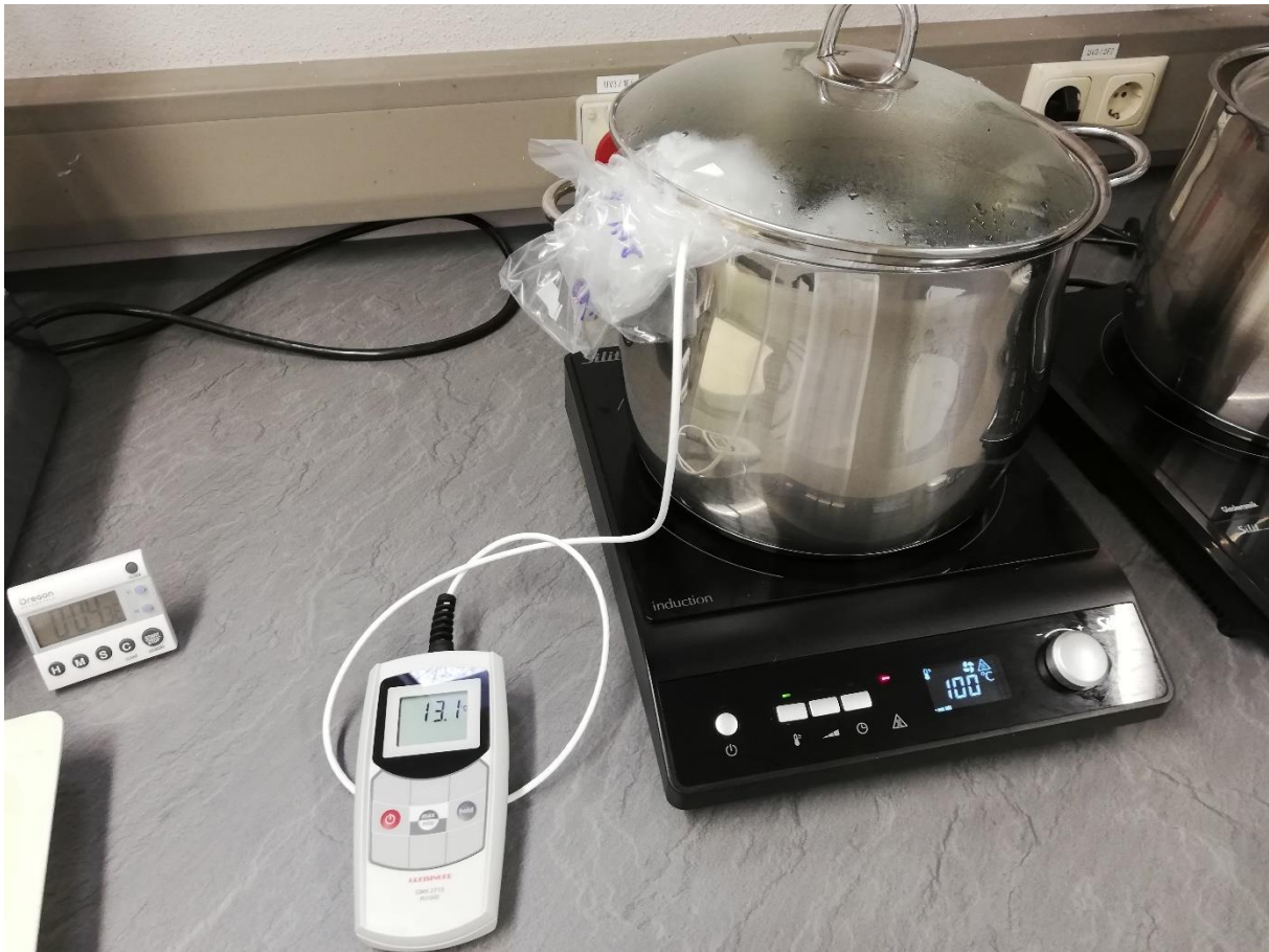
Abbildung 13: Kochen der Proben in Plastikbeuteln bis zu einer Kerntemperatur von 85°C (J. Zeidler).
