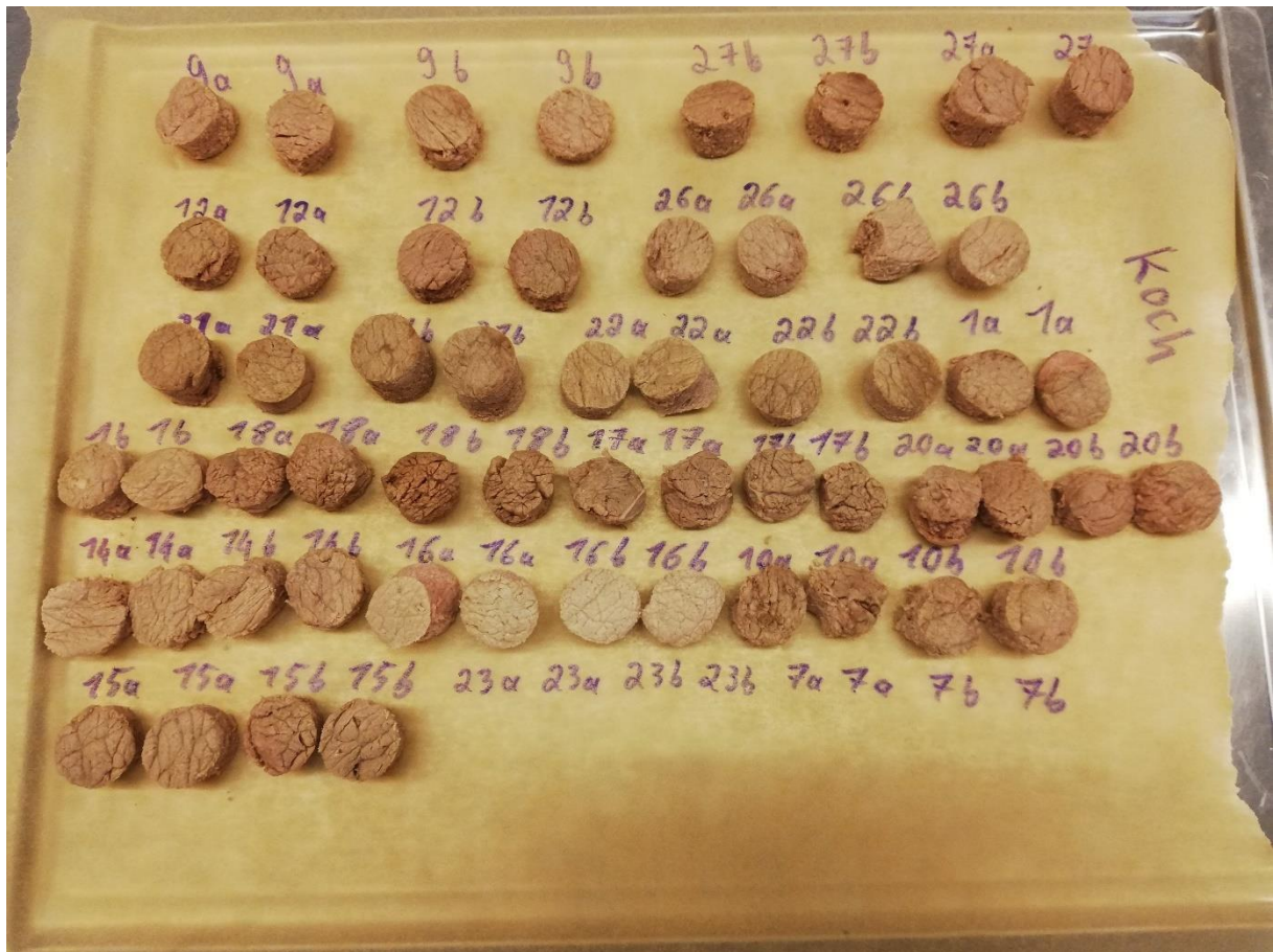
Abbildung 16: Gestanzte Stücke aus den gekochten Proben, bereit für die Scherkraftmessungen (J. Zeidler).
