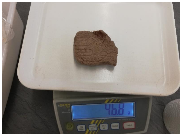
Abbildung 14: Bevor die Proben gekocht gewogen werden, werden sie mit einem Papiertuch abgetupft (J. Zeidler)
