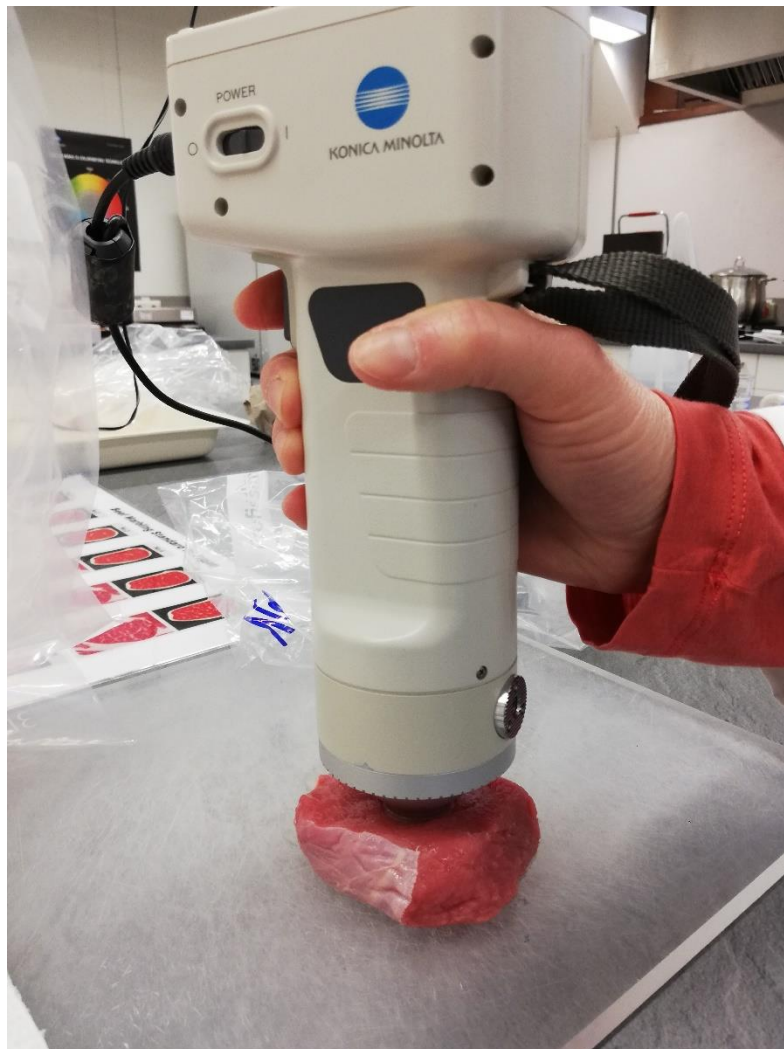
Abbildung 12: Farbmessung mit dem Chroma Meter CR-400 der Firma Konica Minolta (j. Zeidler).
