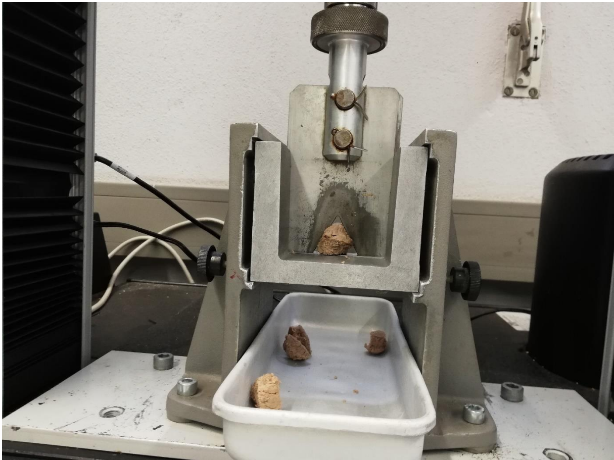
Abbildung 17: Scherkraftmessung anhand des Gerätes Instron 5565 und V-förmiger Warner-Bratzler-Fleischschere (J. Zeidler).
