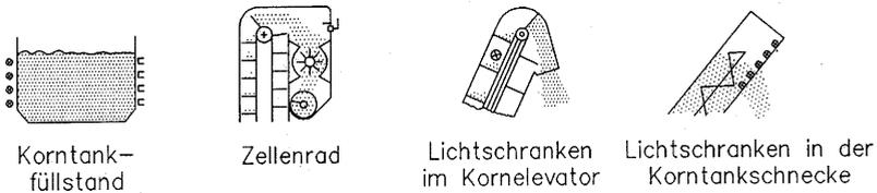
**Bild 7:** Volumetrische Meßverfahren zur Bestimmung des Korndurchsatzes nach [42]
