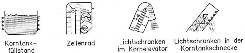
**Bild 8:** Impulsmeßverfahren zur Bestimmung des Korndurchsatzes nach [42]
