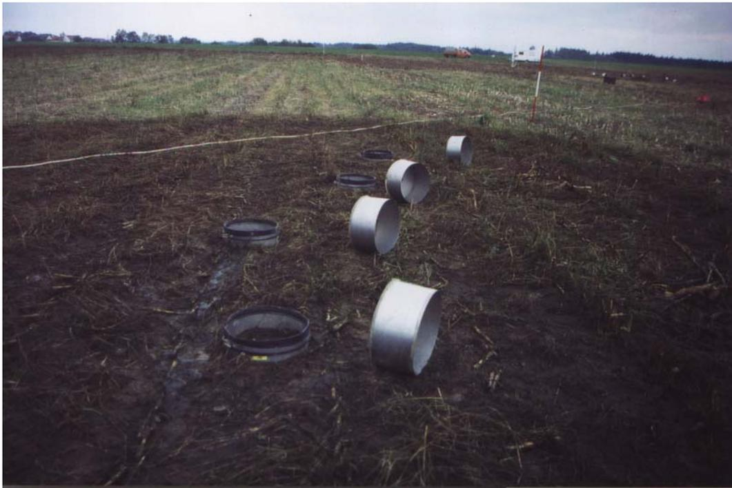
Abb. 2-10: N<sub>2</sub>O-Messkammern nach Schmidt (1998) bei Messungen nach Ausbringung von Flüssigmist auf eine Maisstoppel (Hattenburg, 27.10.1997)
