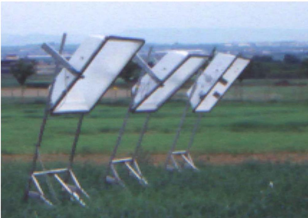
Abb. 2-9: Hohenheimer Messkammer zur Erfassung von Spurengasemissionen im Einsatz auf Grünland, Allgäu (oben) bzw. auf Acker, Hohenheim (unten)
