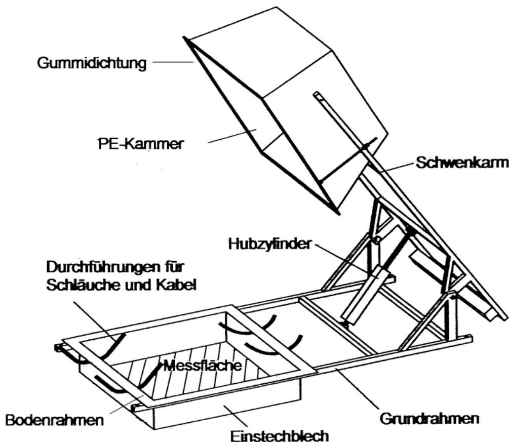
Abb. 2-8: Hohenheimer Messkammer zur Erfassung von Spurengasemissionen (Motz, 2003, verändert)
