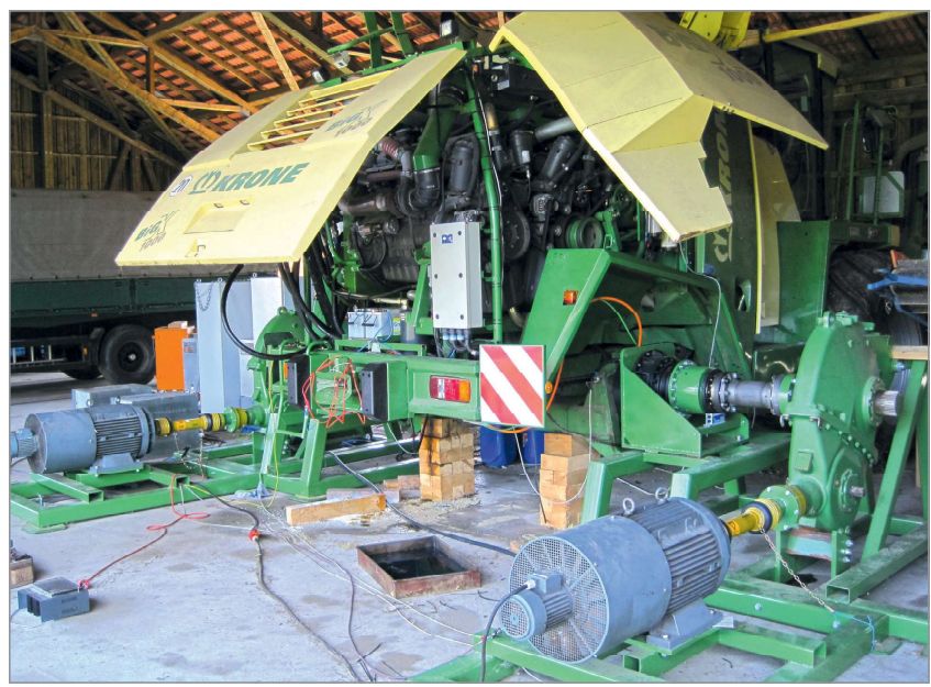
Prüfstand für die Untersuchung der Hinterachsantriebe
