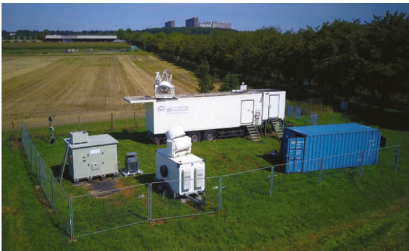
Blick über das LAFO-Gebiet auf der Versuchsstation Heidfeldhof der Universität Hohenheim in Stuttgart. Im Vordergrund sind die zentralen Messgeräte zu sehen. Graues Gehäuse links: der Atmospheric Raman Temperature and Humidity Sounder (ARTHUS). Davor: ein abtastendes Polarisations-Doppler-Wolkenradar. Dahinter: ein Wasserdampf-Differential-Absorptions-Lidar (WVDIAL). Auf dessen Dach rechts: ein Doppler-Lidar.
